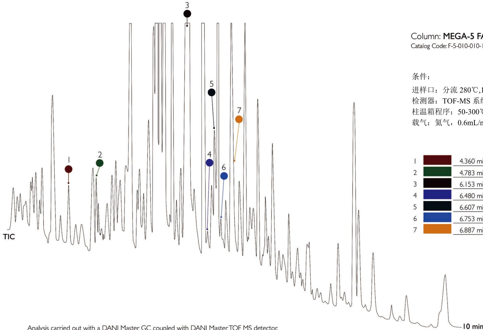
Column: **MEGA-5 FAST - 0.10mm, 0.10µm, 10m**
